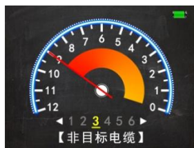
卡在非目标电缆上红橙色光栅 逆时针动态显示或无指示光栅
