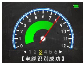
卡在目标电缆上绿色光栅 顺时针动态指示
