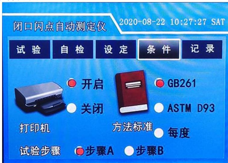
该界面用以设置打印机的开启、关闭及测试试样所符合的标准，采用的标准包括 GB261-2008 和 ASTM D93, 设定为“每度”时，测试试样开始后，在温度上升约 5℃时，每升高 1 度即开盖并点火一次，试验试样是否闪火，适用于并不确知闪点范围的试样。
