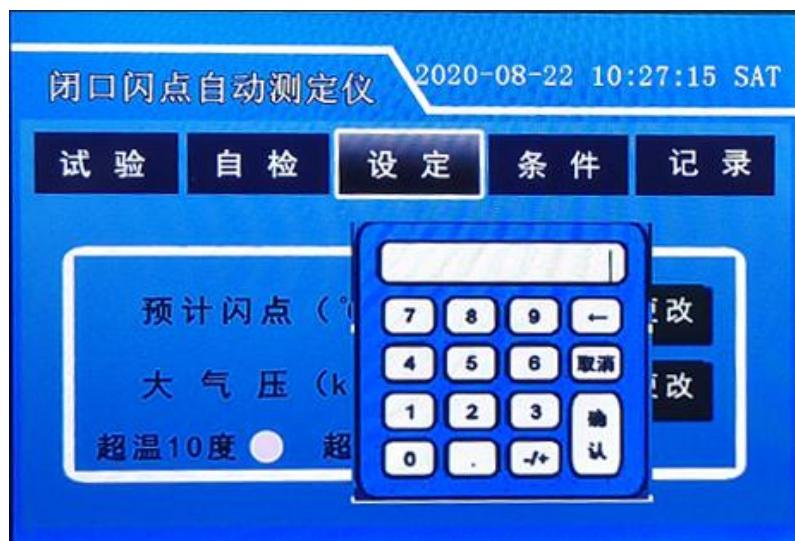
该界面下，点击“设定值”区域，键盘上方预计闪点设定值输入框处光标闪烁，可以输入数字，并按“ $\leftarrow$ ”确认输入。要删除输入的数字，可以点击“ $\leftarrow$ ”。点击右上角的“X”，退出预计闪点设定界面。
