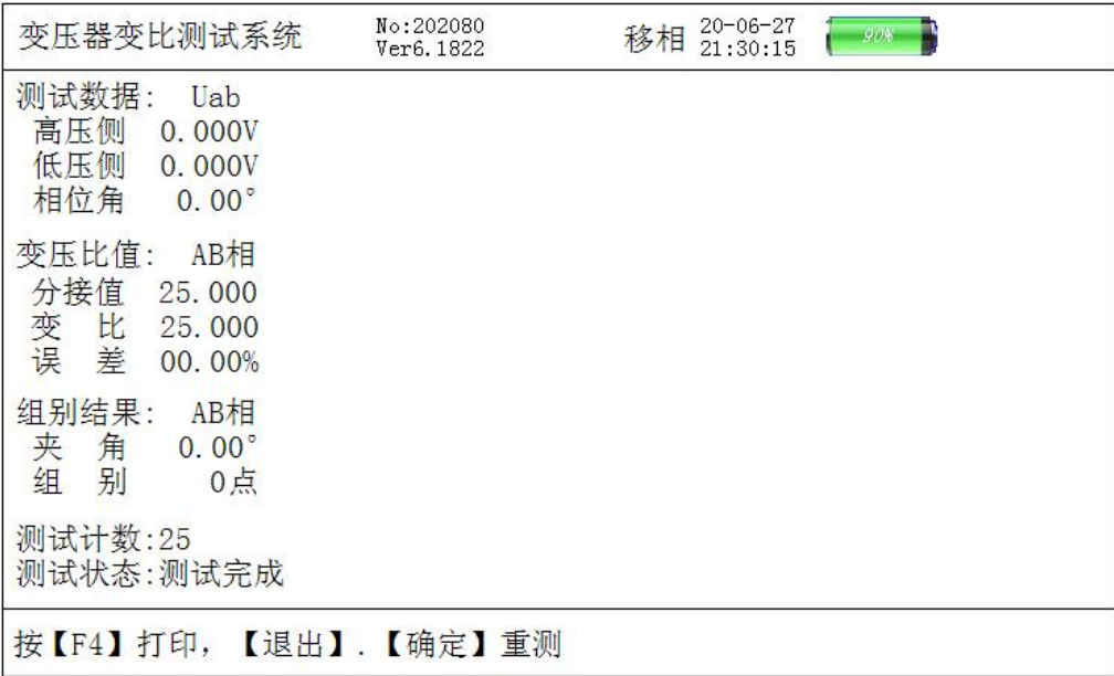
图十、单相变压器测试接线结果屏
