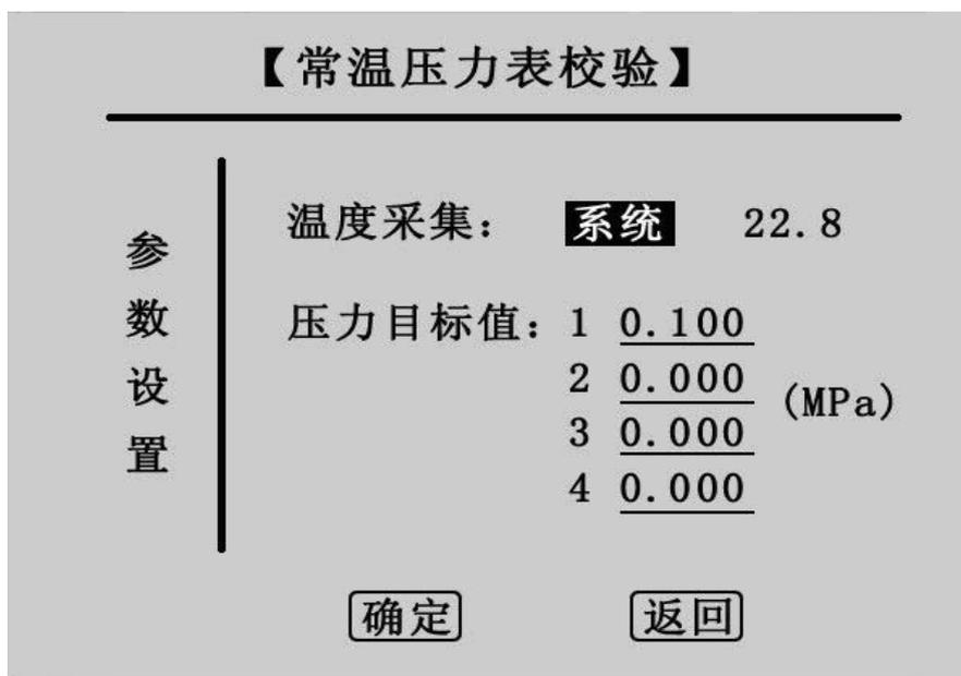
图 3.8 常温压力表校验参数设置界面
