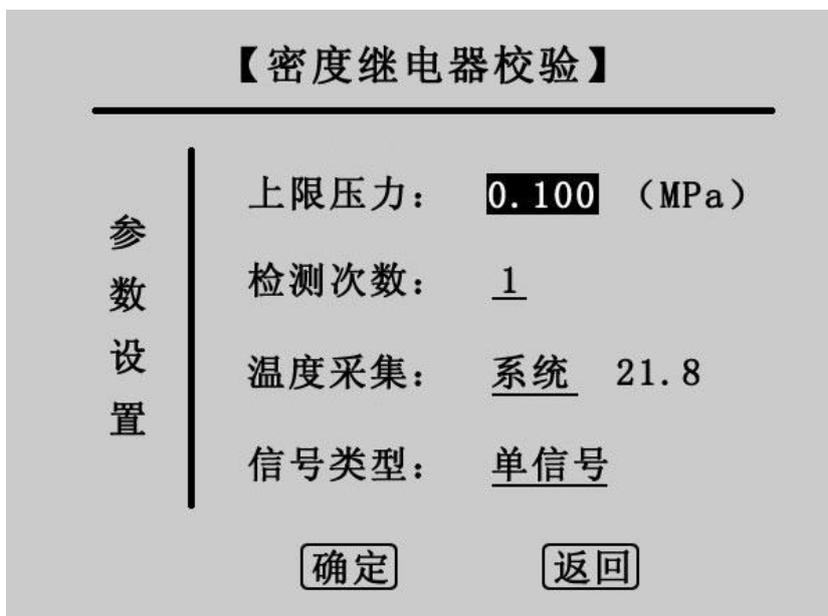
图 3.2 SF<sub>6</sub>密度继电器校验参数设置界面
