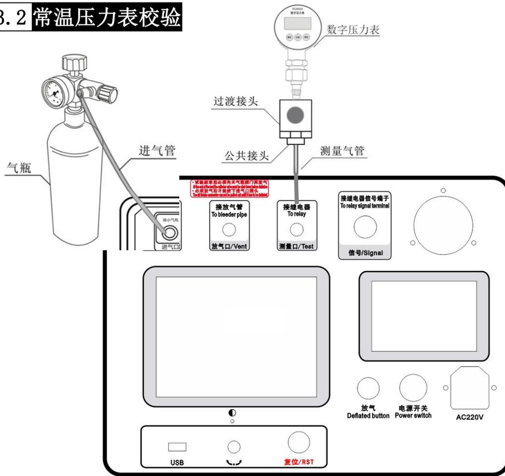
图 3.7 常温压力表校验接线图
