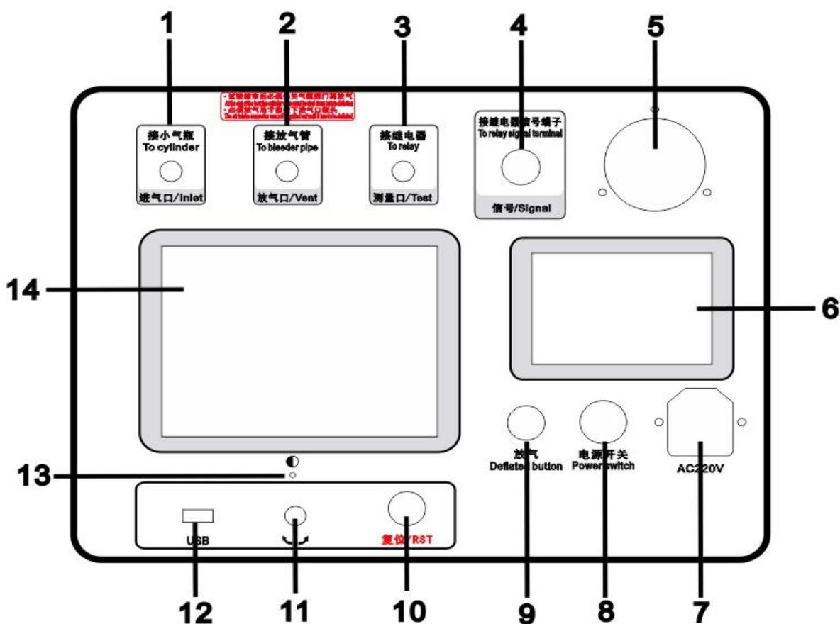
图 1.1 面板结构图
