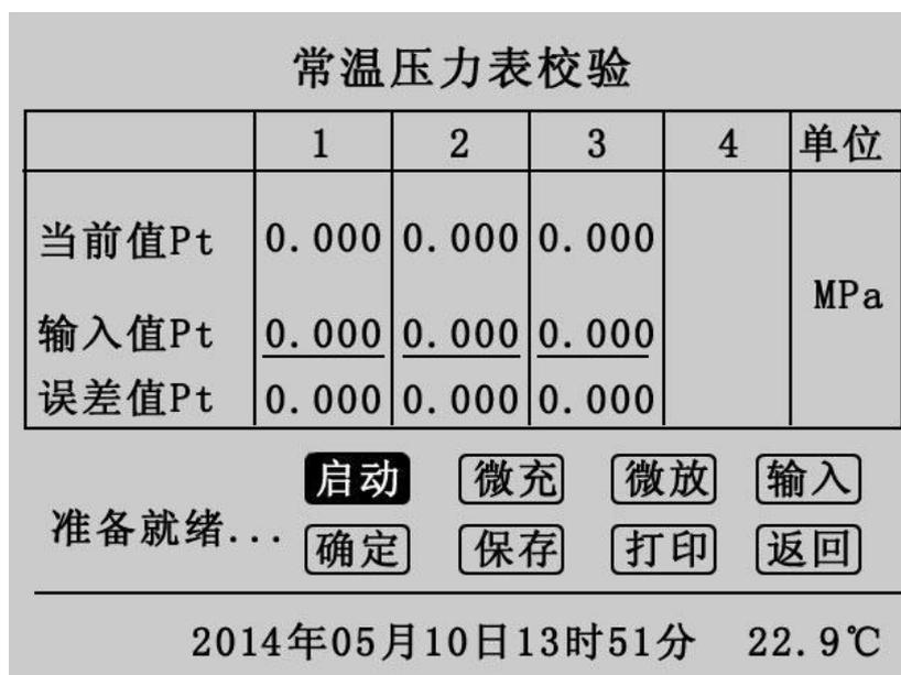
图 3.11 常温压力表校验界面
