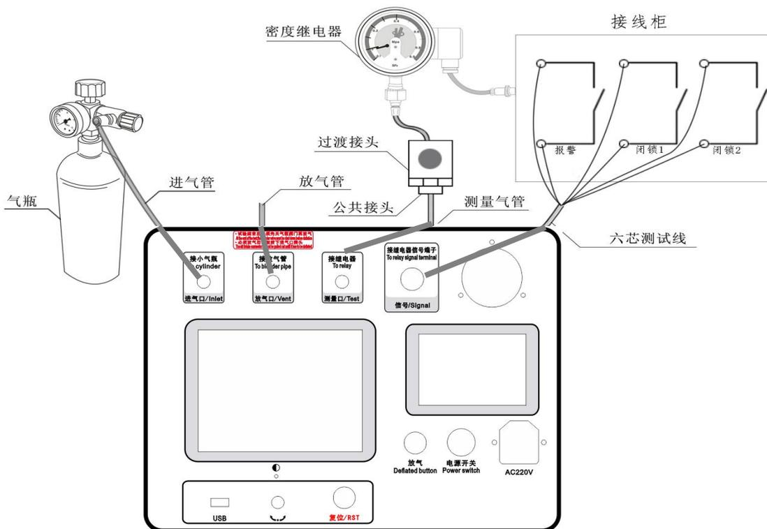
图 3.1 密度继电器校验接线图
