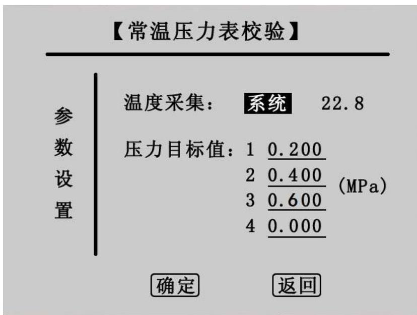
图 3.10 设置三组压力值测试点
