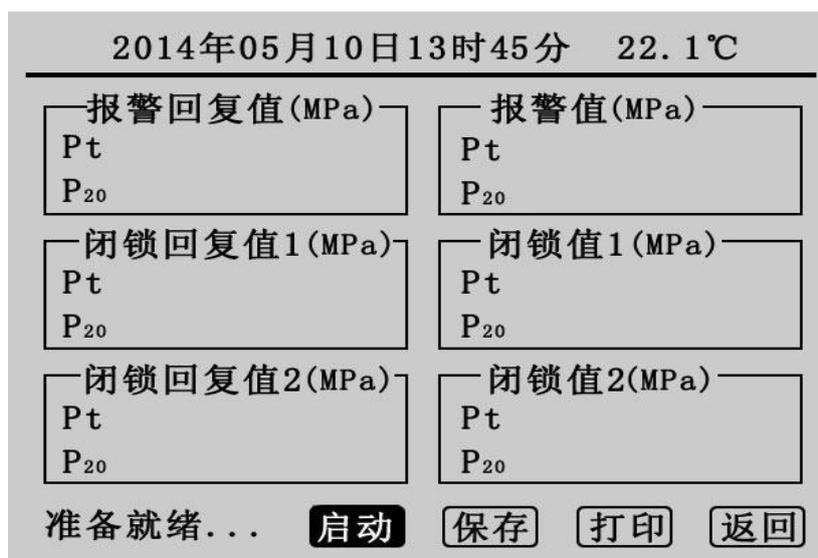
图 3.3 SF<sub>6</sub>密度继电器校验测试界面
