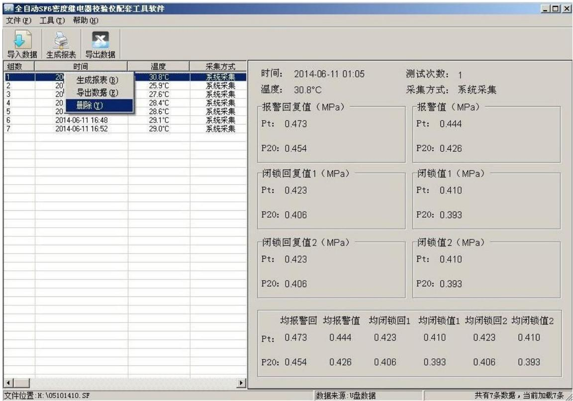
图 4.9 全自动 SF6 密度继电器校验仪删除操作
