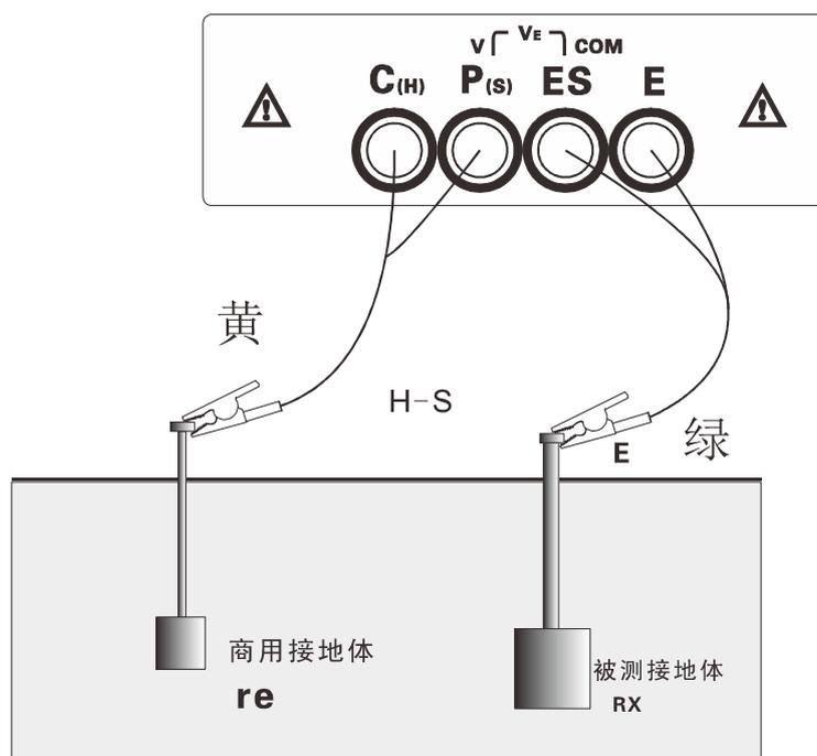
二线简易法测量接地电阻，其仪表读数为被测接地体的接地电阻值与商用接地体的接地电阻值之和，即：
