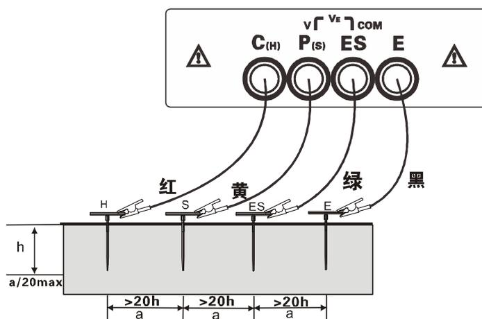
辅助接地棒的间距设置：连接好测试线后，开机按功能按键  $\rho$ ，进入土壤电阻率测试模式，长按“**SET**”键(超过3秒)进入辅助接地棒的间距设置，短按“**▲**”键移动光标，按“**▼**”或“**▶**”键改变当前数字大小( $a$ 值范围:1m~100m)，再长按“**SET**”键(超过3秒)保存设定的  $a$  值，并返回土壤电阻率测试模式。
