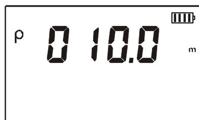
设定完  $a$  值后，在土壤电阻率测试模式下，按“**TEST**”键开始测试，并倒计数显示测试进度，完成测试后显示稳定的土壤电阻率值。
