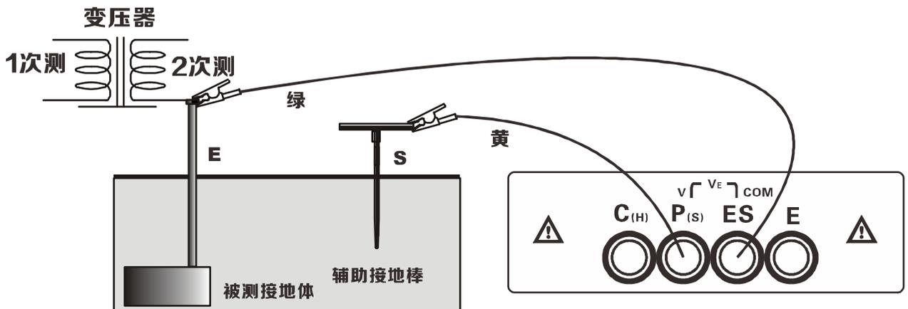
商用接地体对地电压测试
