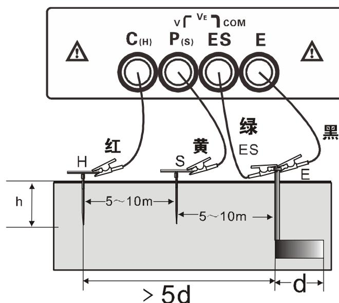
对于多点独立接地系统或大地网接地系统，用户自行选用更长的测试线即可，电极间距大于被测试地网最大对角线长的 5 倍即可。如下图：
