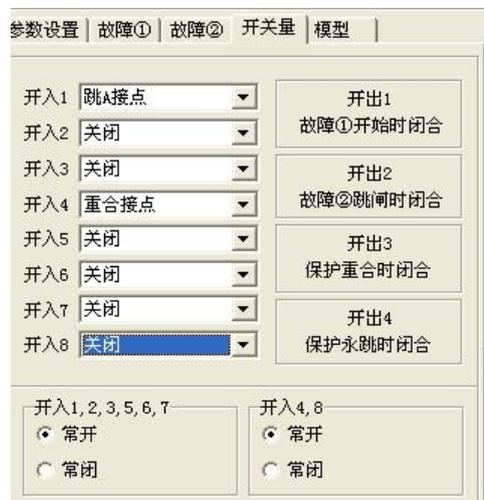
保护的重合闸动作接点。开关形式可选【常开】或【常闭】。故障 1 开始时，开出量 1 闭合。故障 2 跳闸时，开出量 2 闭合。保护的重合闸动作时，开出量 3 闭合。保护永跳（第二次跳闸）时，开出量 4 闭合。
