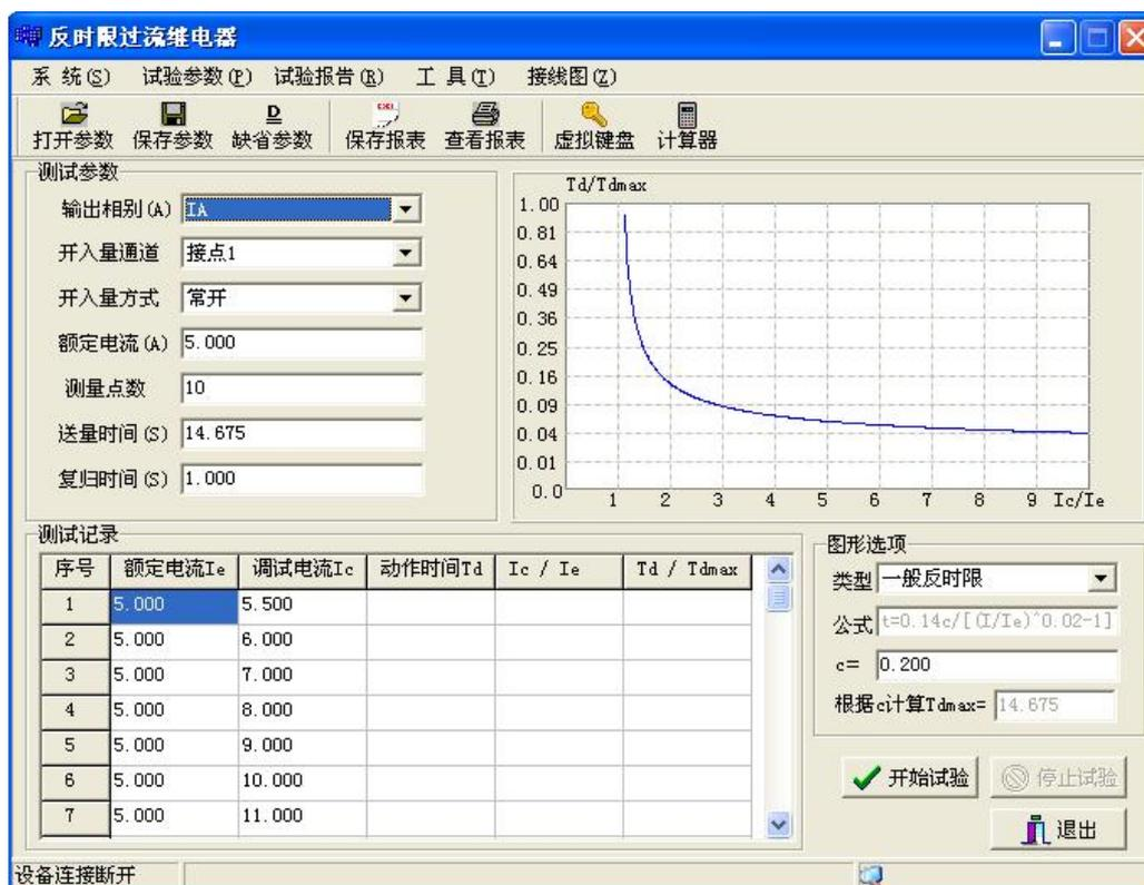
设置一组电流，程序自动测试每个电流下的继电器的动作时间，并在坐标系中绘制动作电流与动作时间的关系曲线。可做单相反时限试验也可做三相反时限试验。
