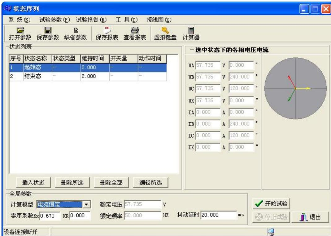
本程序为多个状态按给定的时间连续输出，从起始态开始到结束态为止，最多可输出 20 个状态。状态类型可分为：空载、任意；AN、BN、CN；AB、BC、CA；ABN、BCN、CAN 和 ABC。起始态和结束态固定为空载状态或任
