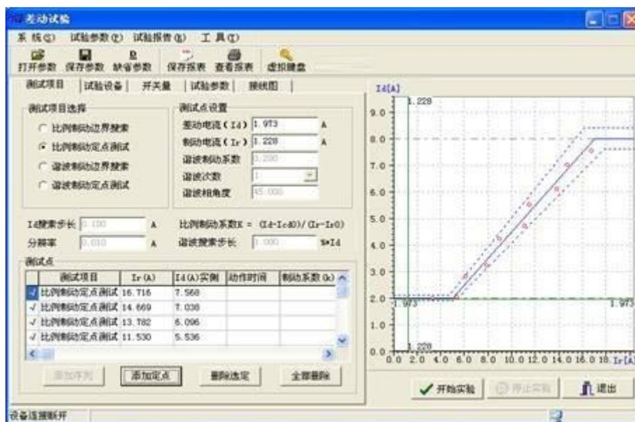
将鼠标移到特性曲线的坐标系中，单击鼠标左键，再点击【添加定点】按钮，表示将此点添加到测试表格中，如此重复多次，可添加多个测试点，如图所示。测试点应选择在做作区与不动作区之间，以验证曲线的正确与否。点击【开始试验】即可进行试验。
