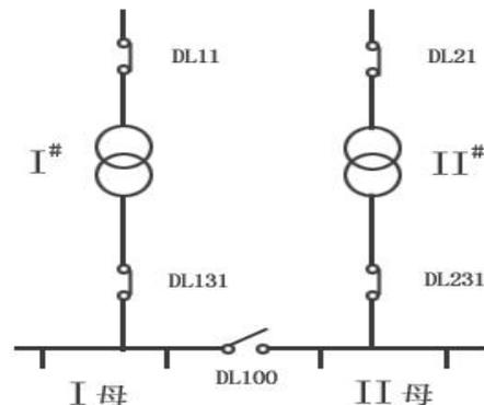
备自投动作：当备自投判断 1#母线无流、无压时，备自投动作，DL131 断
