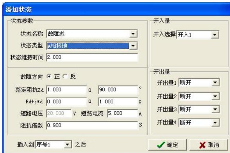
程序默认状态只有两个状态，分别为起始态和结束态。中间可插入各种故障态，两个故障态之间最好插入一个空载状态作为过渡状态，该状态的时间应选 10 秒以上，以使保护整组复归或重合闸充电完毕。各故障态的故障类型、故障阻抗、短路电流、维持时间及开关量等参数可自行选择，两个相邻状态的开入通道不能选同一个，必须错开，以便程序准确记录动作时间。
