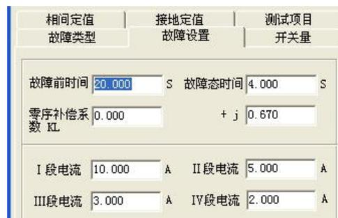
【I 段短路电流】：I 段阻抗一般比较小，为使短路电压抬高，应将短路电流设置大些，一般为 10A。
