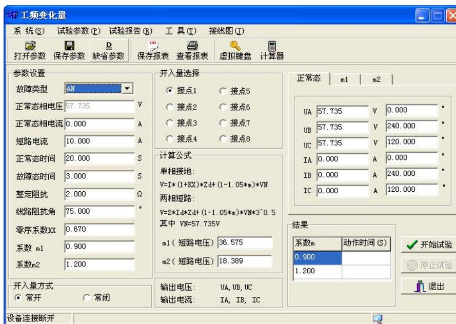
本程序分别模拟 U 相、V 相、W 相单相接地瞬时故障和 uv、vw、wu 相间瞬时故障。模拟故障电流为固定电流，模拟故障前电压为额定电压 57.73V，模拟故障时间一般为 100-150ms，单相接地故障时，短路电压  $V = (1+K) I \times ZD + (1-1.05m) \times Un$ 。相间短路时故障电压  $U = 2 \times I \times ZD + (1-1.05m) \times \sqrt{3} Un$ ，式中 m 为系数，其值分别为 0.9 和 1.2，对于微机保护，当 m=0.9 时，D++ 出口（方向元件出口），当 m=1.2 时，DZ、D++ 都应出口，DZ 为突变量距离出口，DZ 先动作，可投入主保护及零序保护，其余保护应退出。
