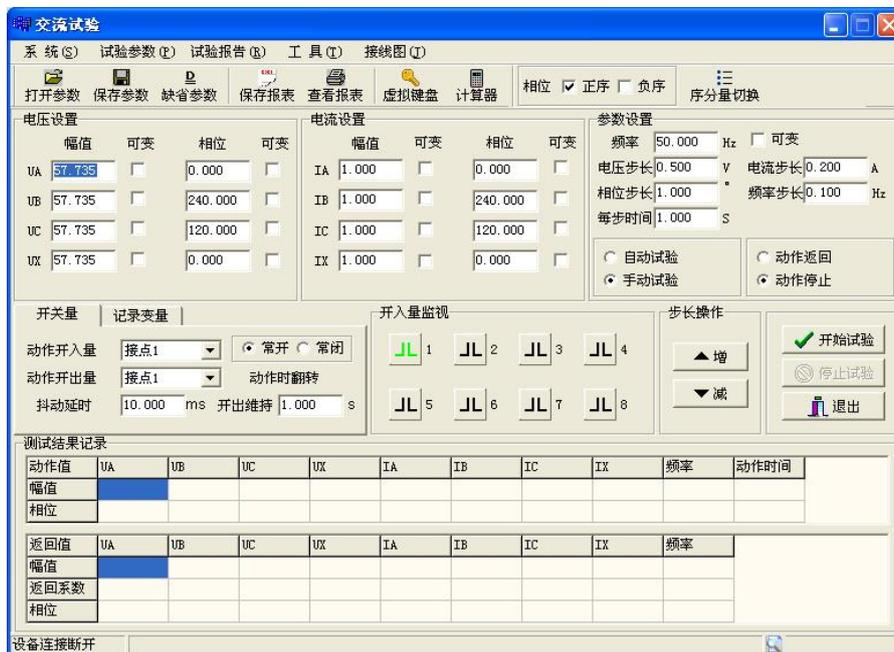
【交流试验】模块是一个通用型，综合性测试模块，它有独立的3相电流和4相电压组成（本仪器）。通过设置相应的电压或电流为变量，赋予变量一定的变化步长，并且选择合适的试验方式（如手动，自动，动作停止，动作返回），方便地测试各种电压，电流保护的動作值，返回值及動作时间等，并自动计算返回系数。
