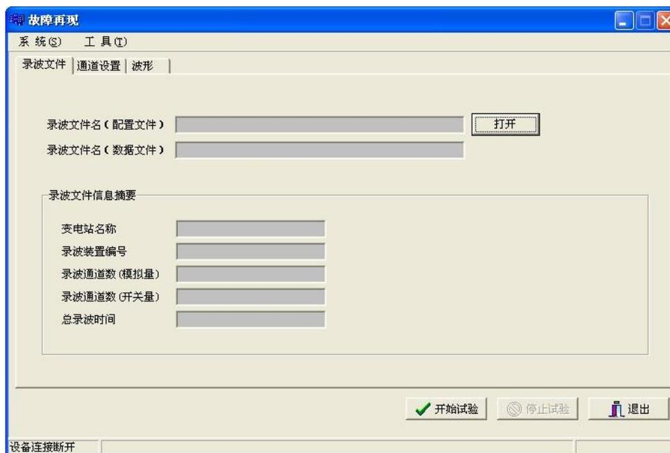
本程序是将 Comtrade 格式的录波文件读出，在界面上显示变电站名称、模拟量通道数、开关量通道数、各段数据的采样频率及采样点数和总采样点数等信息。用户再自行定义测试仪的电压通道、电流通道的对应于录波文件中的相应通道，然后可计算波形并显示在屏幕上，点击【输出】按钮即
