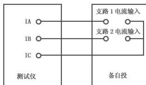
因所带负荷超出变压器的允许最大负荷，要求甩负荷，一般通过判断自投后的电流是否超过整定的过流动作值来确定变压器是否超载。
