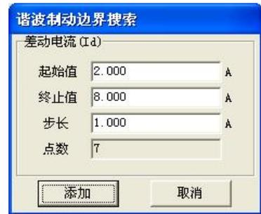
1.00A。设置参数后，点击【添加】，即将这组数据添加到测试表格中，再点击【开始试验】即可。
