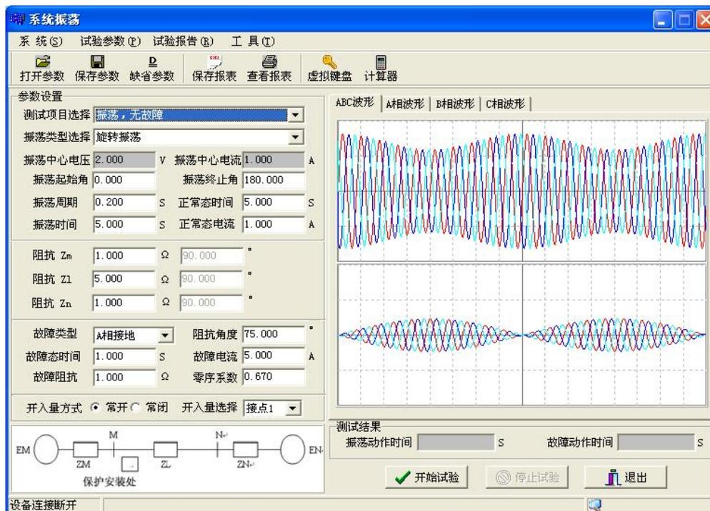
用户输入【振荡周期】一般为 0.2s，【振荡持续时间】为 3 秒，输出电压、电流都在第一路：UA、UB、UC；IA、IB 和 IC。
