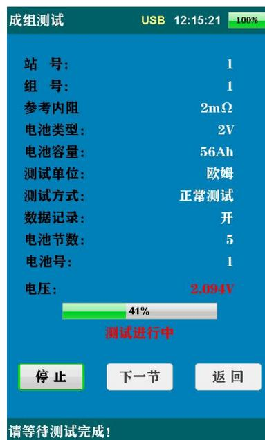
成组电池测量界面如下，其测量操作方法与单节电池测量相似，只是增加了电池节数，在一组电池测试完之后，可以直接点击【下一节】按钮，电池号会自动增加，并进行测试。
