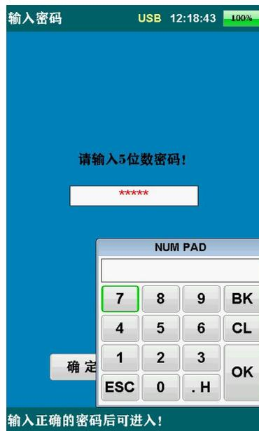
在进入数据校准页面前会打开输入密码页面，必须输入正确的密码后才可以进行，机器默认密码为：“13915”。
