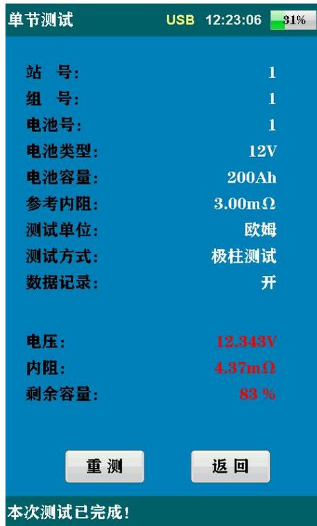
单节测量完成以后，会自动显示出内阻/电导值，但电压值是实时显示的。如果是连接条测试模式，该界面还会有连条测试值。
