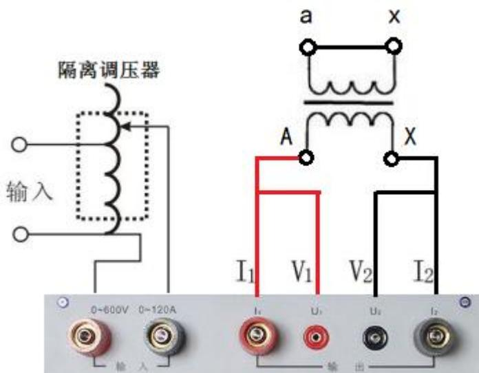
图 6-21 单相变压器短路试验接线图
