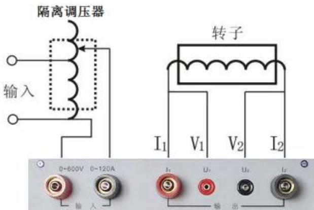
图 5-1 交流阻抗试验接线图
