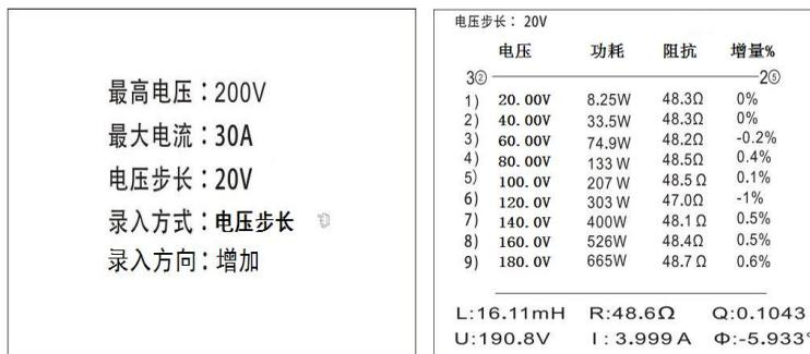
图 6-3 设置为电压步长
