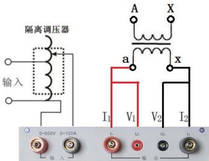
图 6-19 单相变压器空载试验接线图
