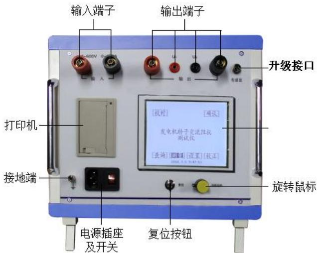
图 4-1 阻抗测试仪面板
