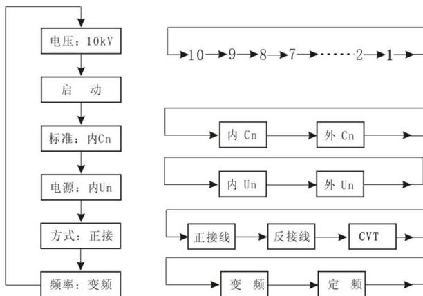
图 21 光标移动流程图
