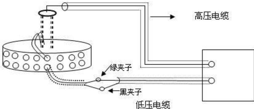
图 18 标准电容 BR26、介损器 DB-100 等正接线（非接地试品）接线法
