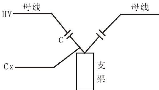
图 15 断路器断口电容试验接线
