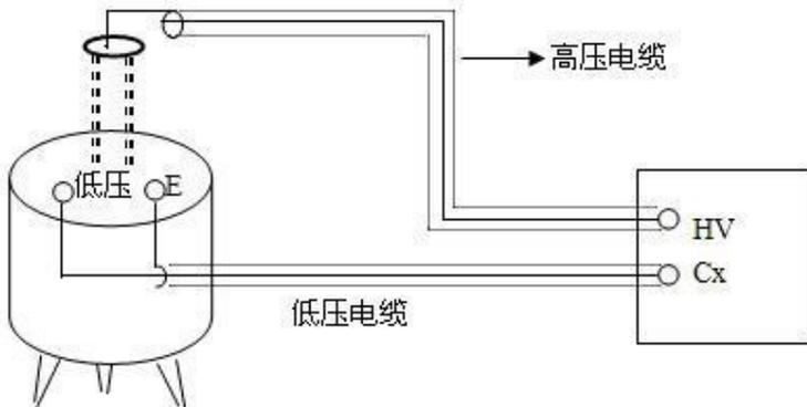
图 16 标准电容 BR16 正接线（非接地试品）接线法
