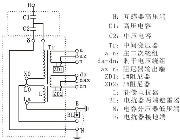
图 7 TYD35/ $\sqrt{3}$ -0.02H 电容式电压互感器
