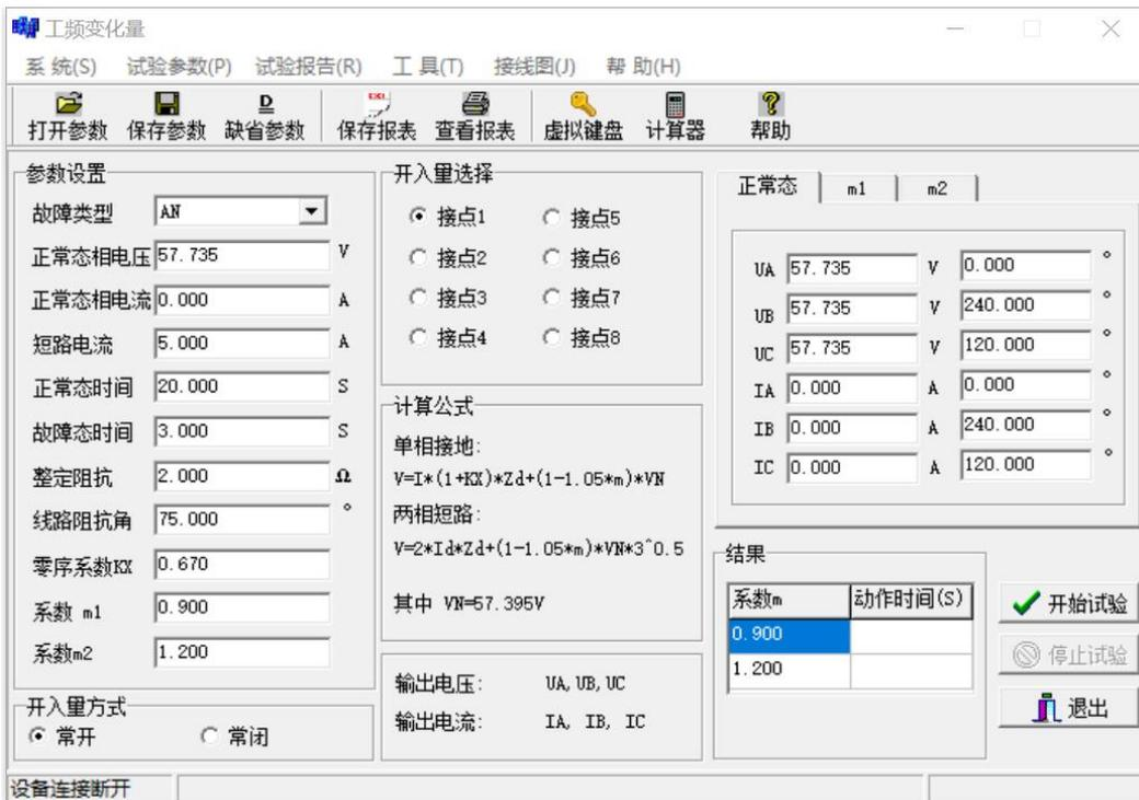
本程序分别模拟 U 相、V 相、W 相单相接地瞬时故障和 uv、vw、wu 相间瞬时故障。模拟故障电流为固定电流，模拟故障前电压为额定电压 57.73V，模拟故障时间一般为 100-150ms，单相接地故障时，短路电压  $V = (1+K) I \times ZD + (1 - 1.05m) \times Un$ 。相间短路时故障电压  $U = 2 \times I \times ZD + (1 - 1.05m) \times \sqrt{3} Un$ ，式中 m 为系数，其值分别为 0.9 和 1.2，对于
