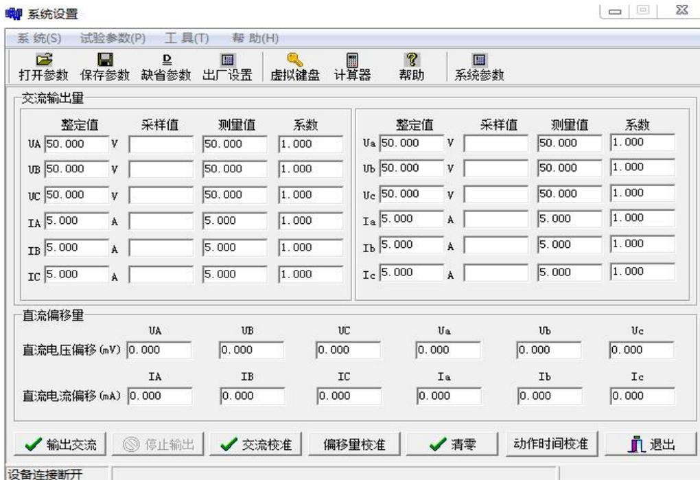
本模块用于装置的精度和直流偏移的校准。本仪器的精度和直流偏移是采用软件自动进行校准，而不是采用传统的电位器调整模式，采用软件校准的优点是精度高，使用方便。使用方法如下：
