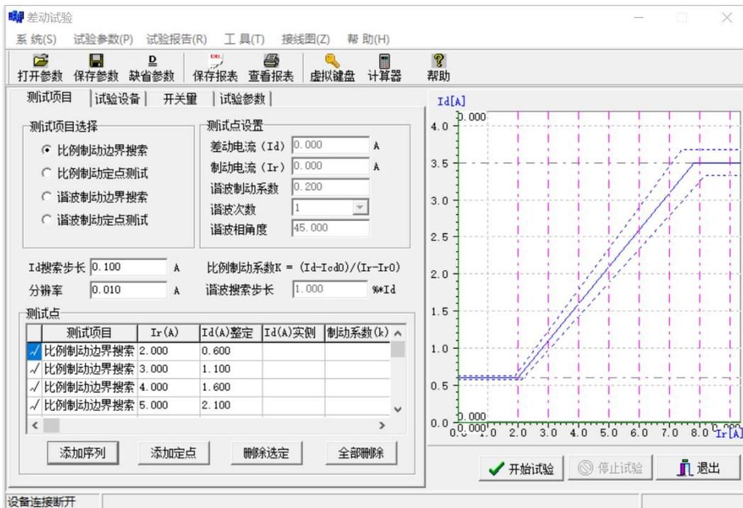
本程序用于试验微机型差动保护装置的比例制动特性和谐波制动特性。本仪器是三相电流差动试验。
