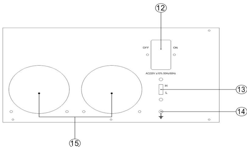
12. 电源输入接口：通过配套连接线，接入 AC220V 交流电压，内部保险规格：10A，5mm\*10mm；ON 开：为电源开，OFF 关：为电源关
