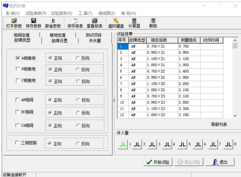
本程序用于三段式或四段式距离保护的阻抗定值校验。一般在 110KV 以上电压等级的变电站中的线路保护，才配备距离保护装置。
