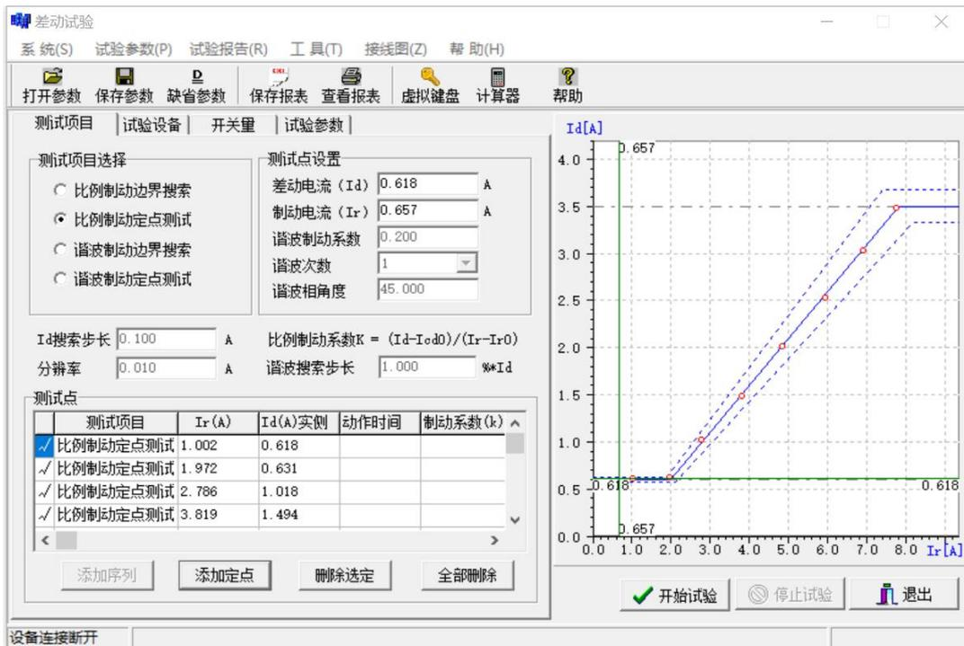
将鼠标移到特性曲线的坐标系中，单击鼠标左键，再点击【添加定点】按钮，表示将此点添加到测试表格中，如此重复多次，可添加多个测试点，如图所示。测试点应选择在动作区与不动作区之间，以验证曲线的正确与否。点击【开始试验】即可进行试验。
