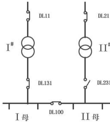
备自投动作后：1#母线有压，1#主变无流，2#母线有压、2#主变有电流。各状态电流、电压设置如下：
