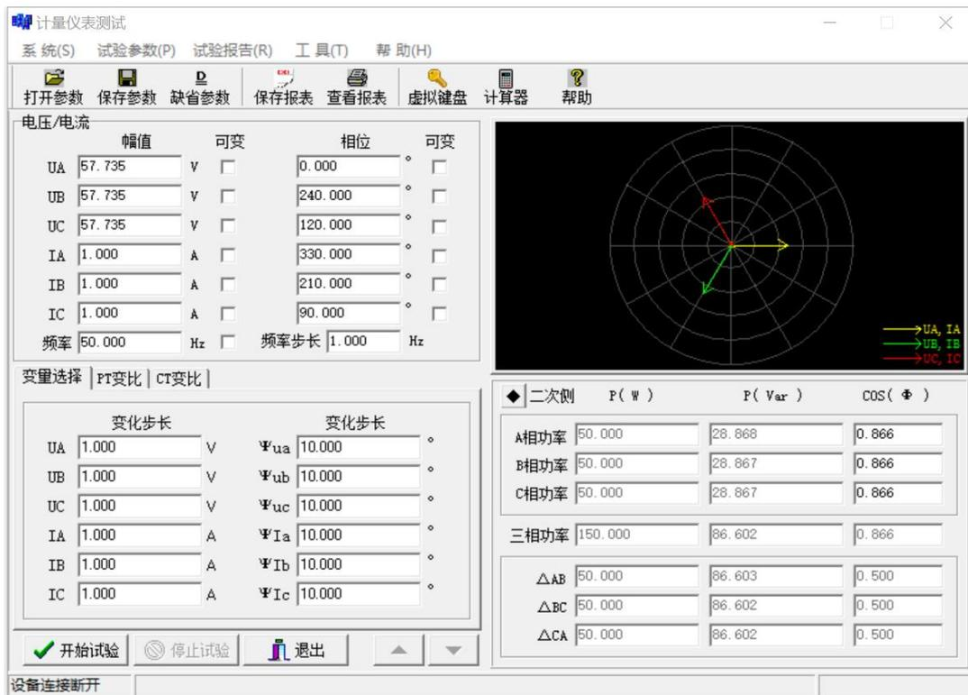
本程序用于检测单相或三相电能表的有功、无功及功率因数。将电流参数和电压参数分别添加到表中相应的栏目，然后点击【开始试验】，将所测得表的读数与界面显示的数据进行对比，测试是否一致。
