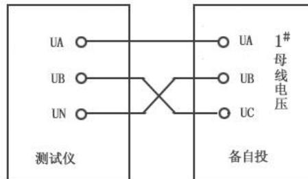
测试仪的输出电压设定如下： $U_A=100V, 0^\circ$ ； $U_B=100V, 60^\circ$ ，则  $U_{AB}=100V, -60^\circ$ 。由于测试仪的输出电压  $U_A$  和  $U_B$  分别加在备自投的  $U_A$  和  $U_C$  上，则备自投侧的电压为：
