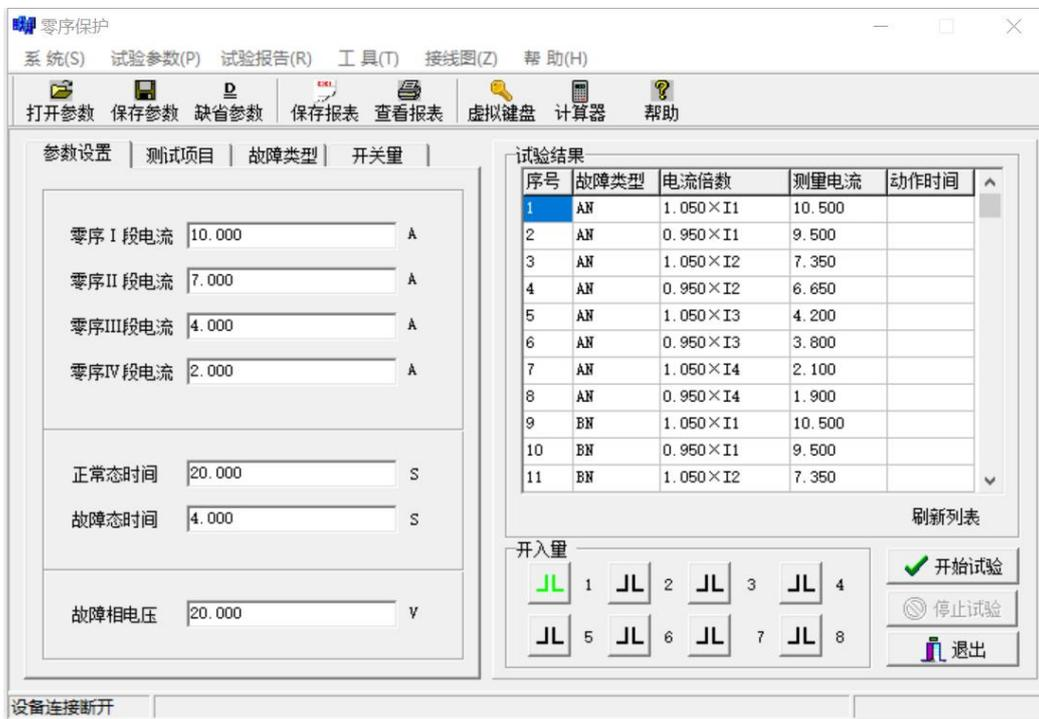
用于测试距离保护的零序过电流项目，零序过电流一般分为4段，1段电流一般为速断出口，2段、3段、4段电流一般为带延时出口，动作时间与电流的大小成反比。
