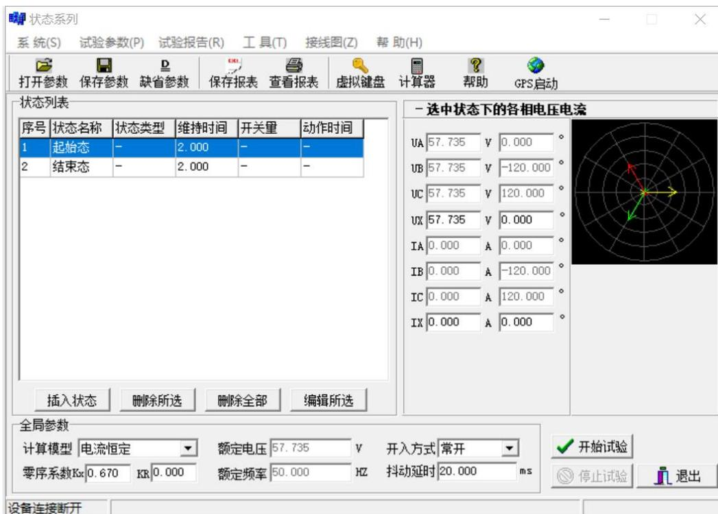
本程序为多个状态按给定的时间连续输出，从起始态开始到结束态为止，最多可输出 20 个状态。状态类型可分为：空载、任意；AN、BN、CN；AB、BC、CA；ABN、BCN、CAN 和 ABC。起始态和结束态固定为空载状态或任意状态，当选择任意状态时，可在右边状态栏里设置各相电流值、电压值及相位。
