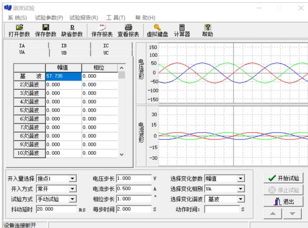
本程序输出三相电流和三相电压，每相电流和电压可在基波上叠加 2—20 次谐波，各次谐波的幅值和相位可任意改变，可以用来测试反映谐波成分的各种装置。
