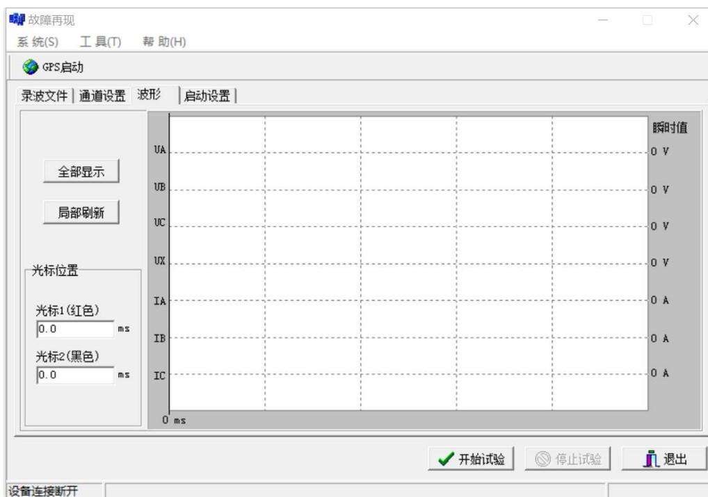
本程序是将 Comtrade 格式的录波文件读出，在界面上显示变电站名称、模拟量通道数、开关量通道数、各段数据的采样频率及采样点数和总采样点数等信息。用户再自行定义测试仪
