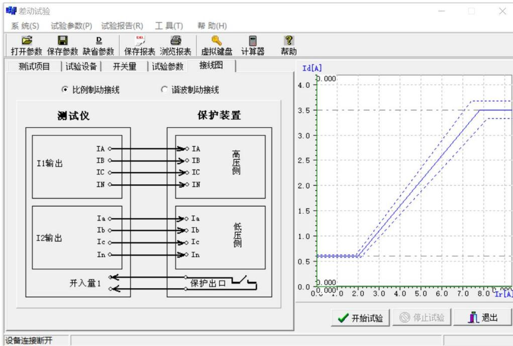
(1).六相比例制动接线：将第一组三相电流接入高压侧，将第二组三相电流接入低压侧即可
