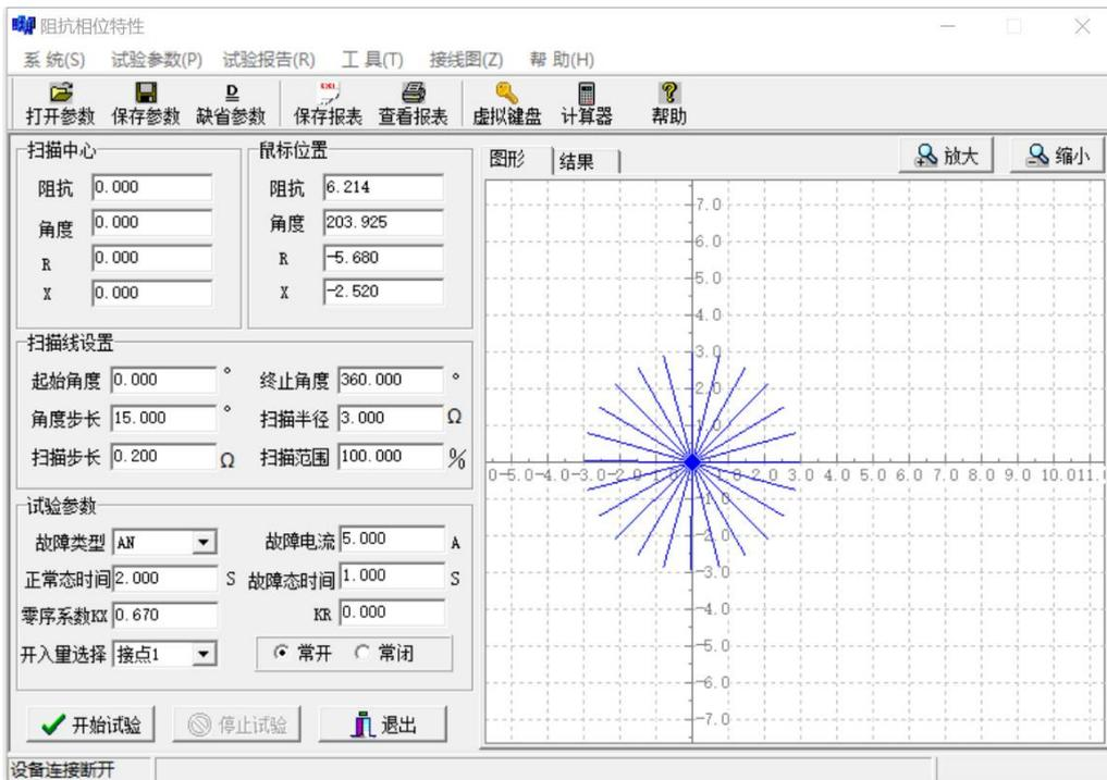
本程序用于测试阻抗继电器的相位特性。适用于园特性、多边形、上抛园、下抛园等特性的阻抗继电器阻抗边界搜索测试。
