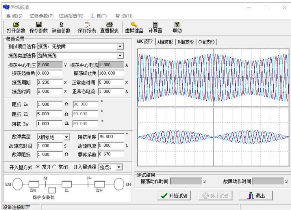
本程序可模拟单机无穷大系统的振荡过程，并可在振荡中加入故障，以测试保护装置能否正确动作。用户输入【振荡周期】一般为 0.2s，【振荡持续时间】为 3 秒，输出电压、电流都在第一路：UA、UB、UC；IA、IB 和 IC。
