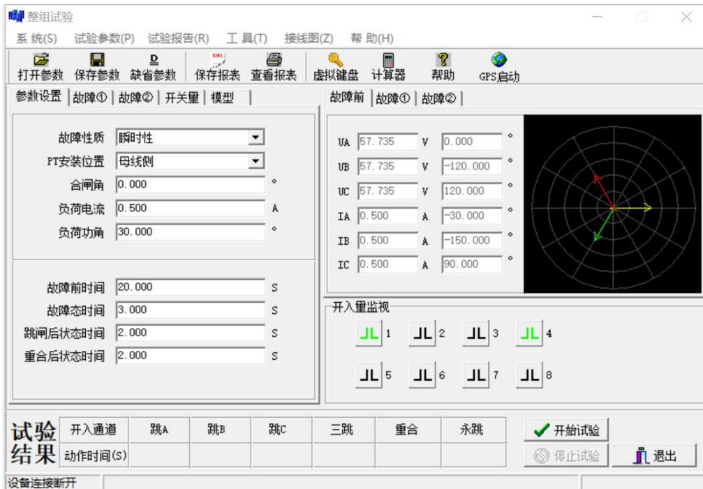
本程序可模拟瞬时性、永久性和转换性故障，用于测试线路保护的重合闸试验、后加速以及带开关做整组传动试验。
